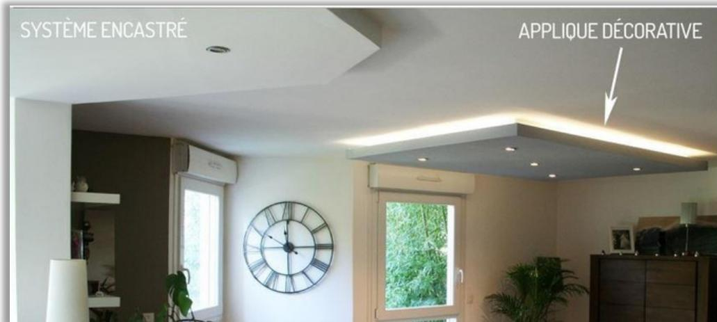
Notre **Plafond Chauffant rayonnant hydraulique très basse température**, (en RT2012 des départs d'eau de 25°C en moyenne sur toute la période de chauffe), **se raccorde à tous types de générateurs** en mode chauffage (pompe à chaleur, chaudière, énergie électrique, solaire, ce dernier est le plus adapté à notre concept ...)
